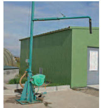
Photo 2 : potence de remplissage (AGRIDEA).
